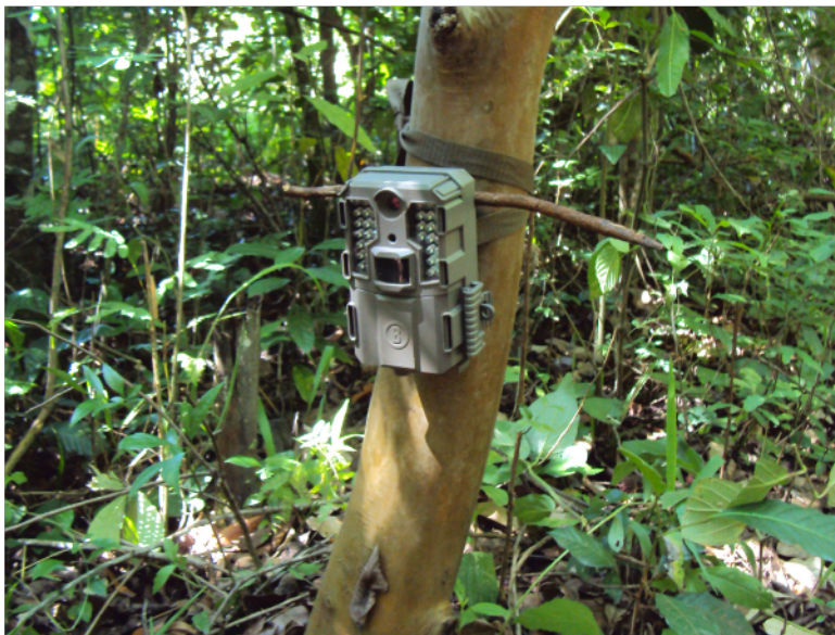
Figura 7 Armadilha fotográfica instalada para amostragem de mamíferos.
