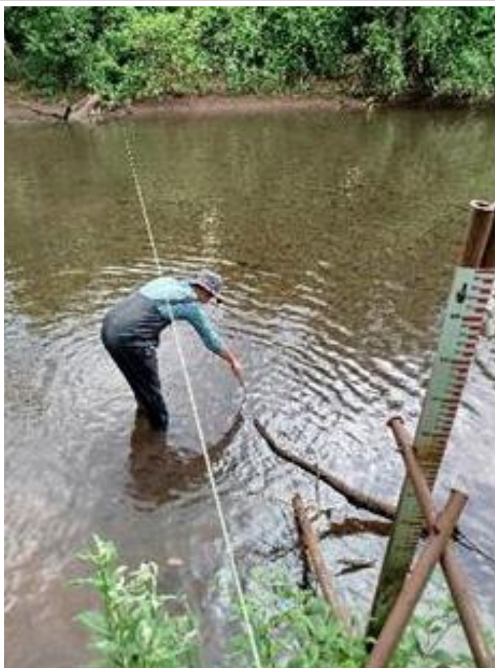
Figura 18: Coleta de sedimentos na CGH Ouro Branco, nov. 2024 HydroPartner Hidrometria Ltda, Rel 19 , em 27.11.2024
